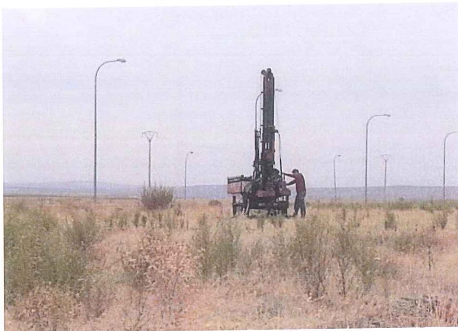
ENSAYO DE PENETRACIÓN DINÁMICA DPSH 2
