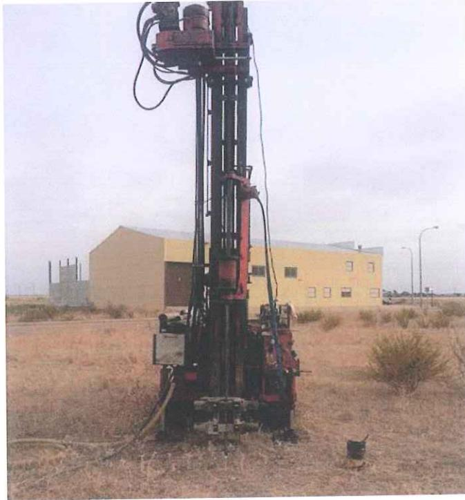
ENSAYO DE PENETRACIÓN DINÁMICA DPSH 1
